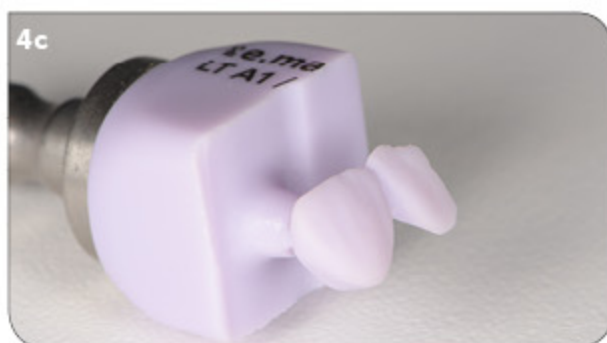
Fig.4c : Fracture de la restauration lors de l'usinage.
